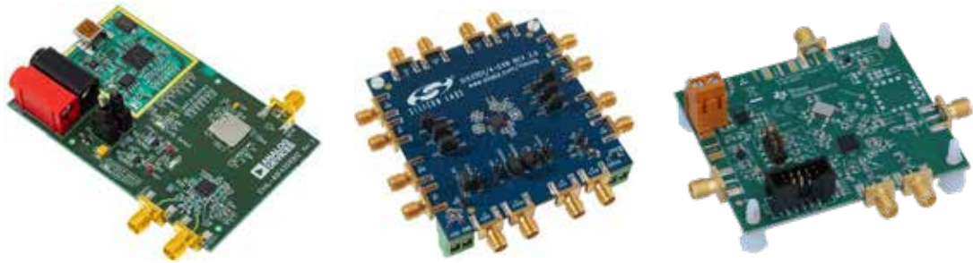
Рис. 2. Відлагоджувальні плати провідних виробників синтезаторів частоти [4–6]
